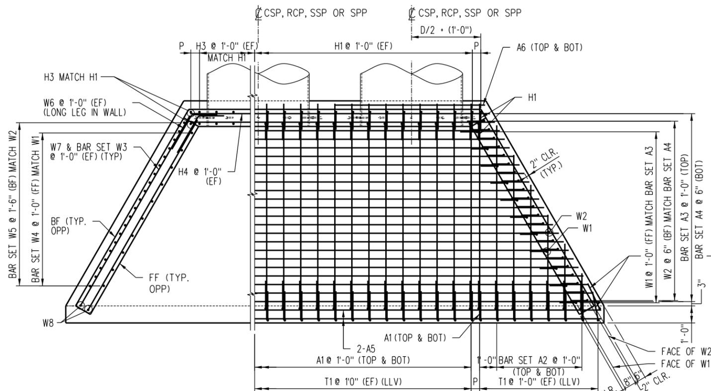
HALF PLAN THRU HEADWALL & WINGWALL
