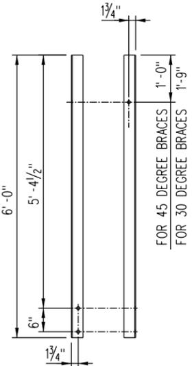
**HANDRAIL ANGLE BRACE MK. AB-35L & AB-35R**
