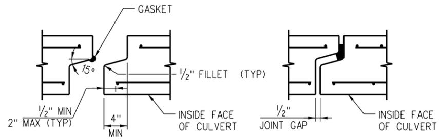
**LONGITUDINAL JOINT DETAIL**
