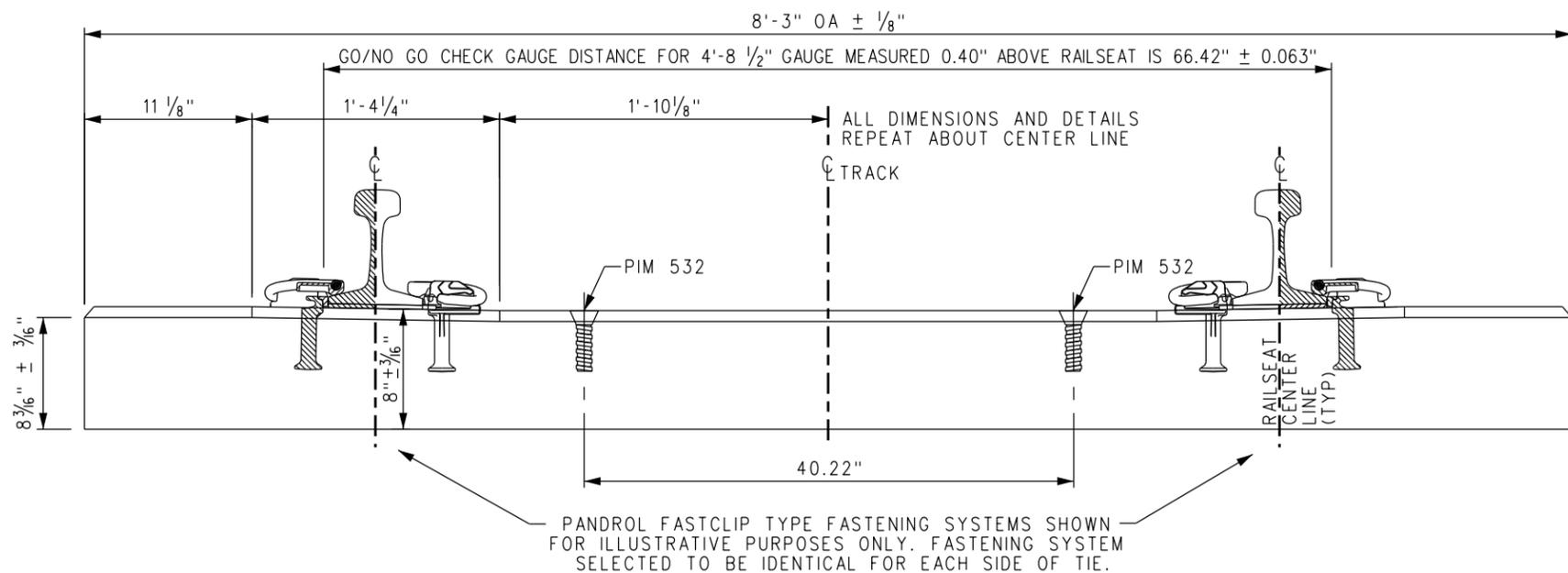
PANDROL FASTCLIP TYPE FASTENING SYSTEMS SHOWN FOR ILLUSTRATIVE PURPOSES ONLY. FASTENING SYSTEM SELECTED TO BE IDENTICAL FOR EACH SIDE OF TIE.
