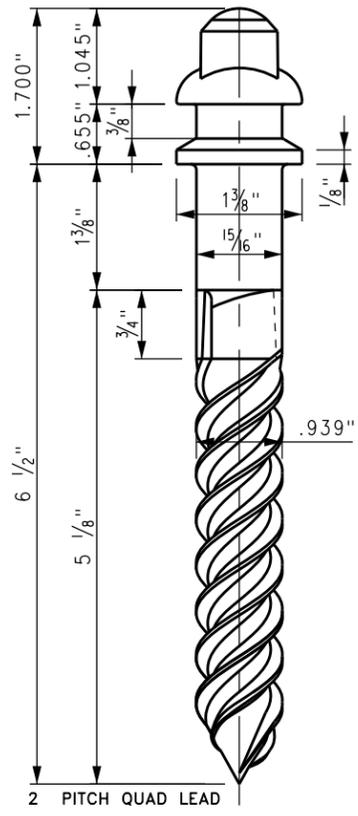
**ELEVATION "EVERGRIP" OR EQUAL SCREW SPIKE**
