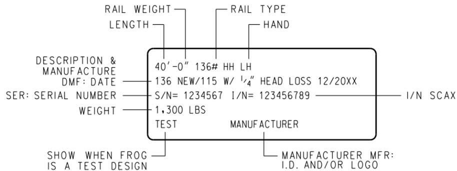
**BONDED INSULATED JOINT & TRANSITION RAIL TAG**
