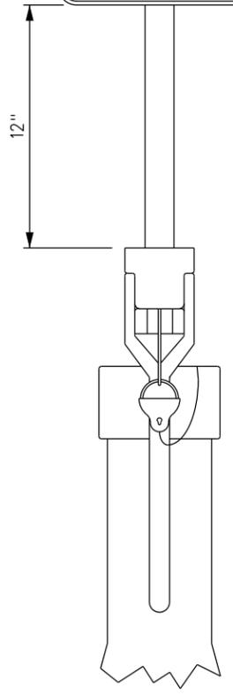
**DERAILING SWITCH TARGET**
