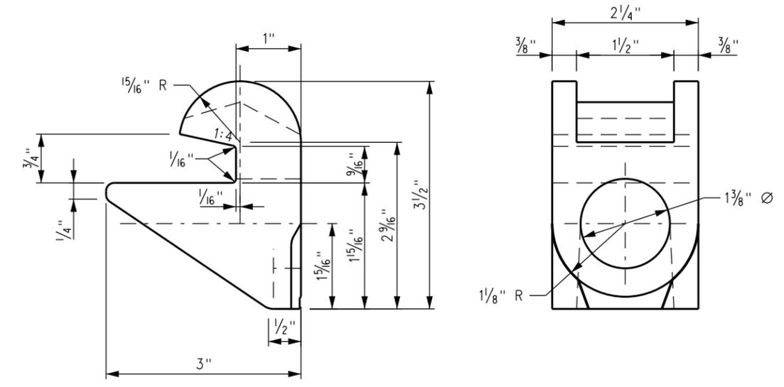
**DETAIL B - CLAMP CASTING**
