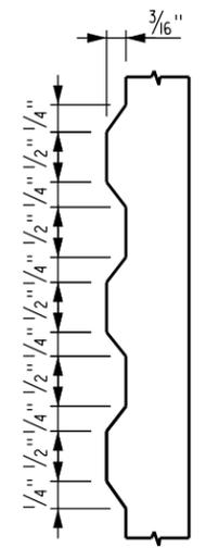
LONGITUDINAL SECTION OF JOINT BAR
