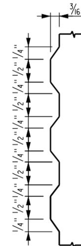
**LONGITUDINAL SECTION OF JOINT BAR**
