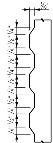
**LONGITUDINAL SECTION OF JOINT BAR**
